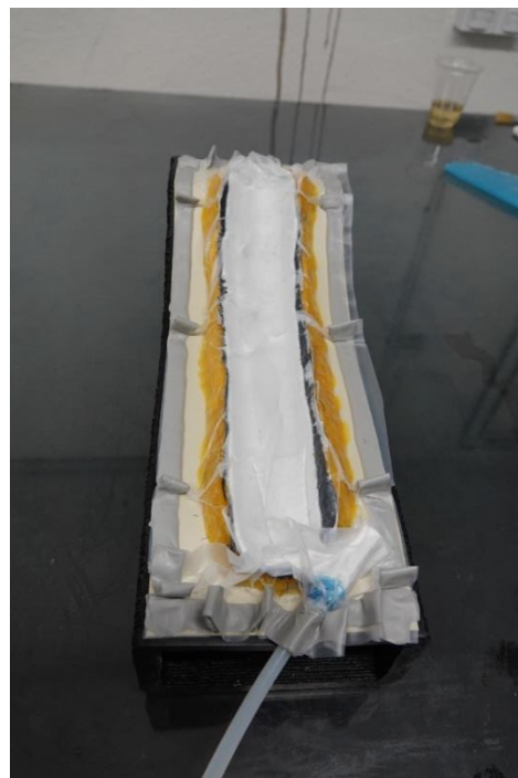
Abb. links: Endkonturnahes additiv gefertigtes Formwerkzeug während des Feinschlichtprozesses; Abb. rechts: Vakuumverdichtetes Laminat während der Konsolidierung
