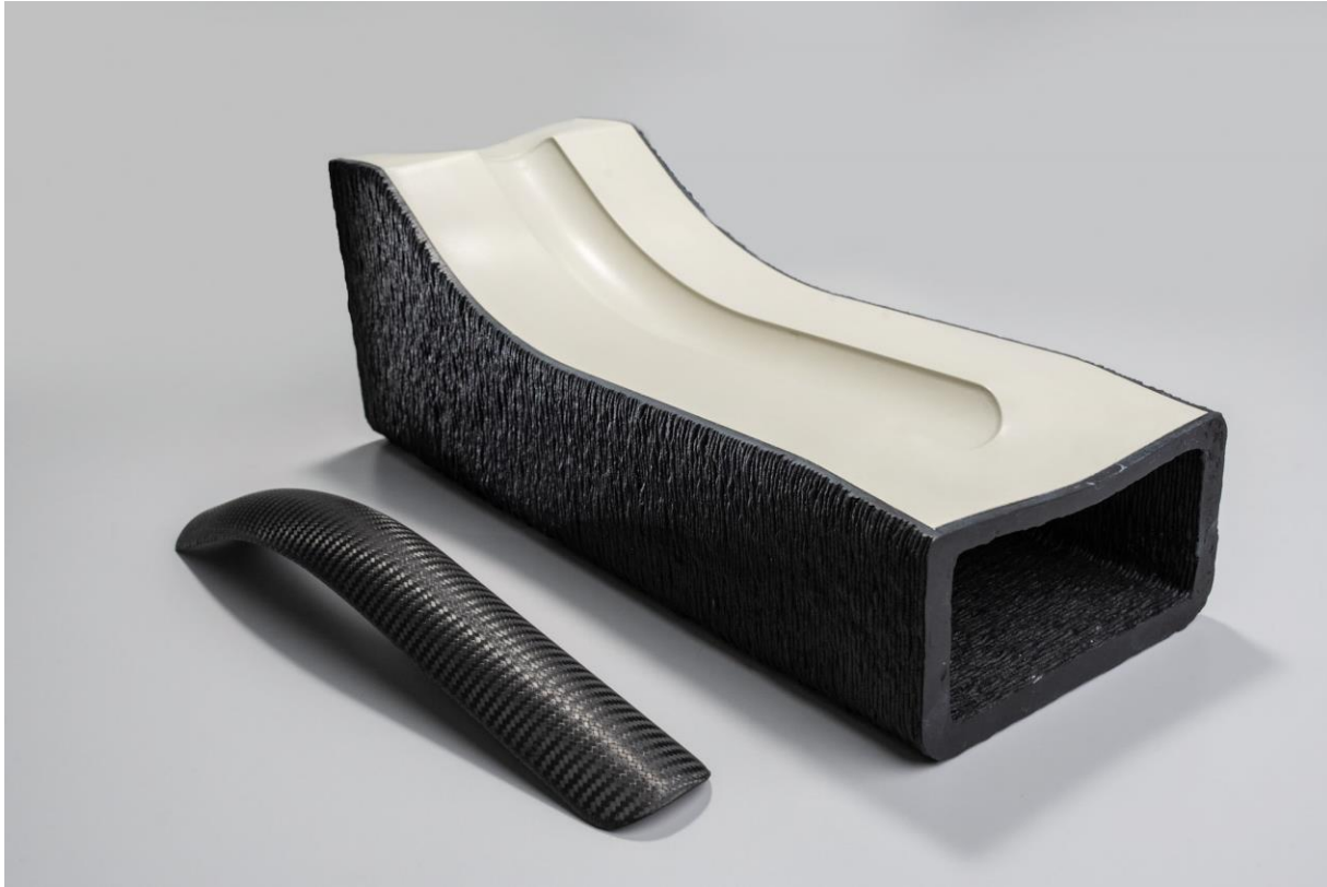
Abb.: Einsatzfähiges Formwerkzeug mit beschichteter Kavität. Im Vordergrund abgeformtes CFK-Bauteil
